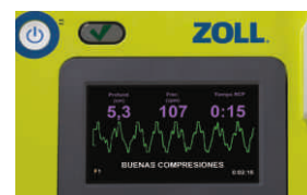
La pantalla de visualización muestra la información de reanimación y el ECG actuales en tiempo real.
