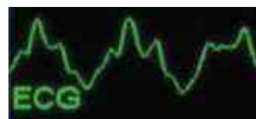
Señal de ECG sin filtrar durante RCP
