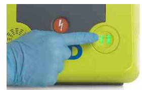
Pulse el botón pediátrico para iniciar el algoritmo de análisis cardíaco pediátrico y reducir la energía administrada. Un solo electrodo para pacientes adultos y pediátricos.
